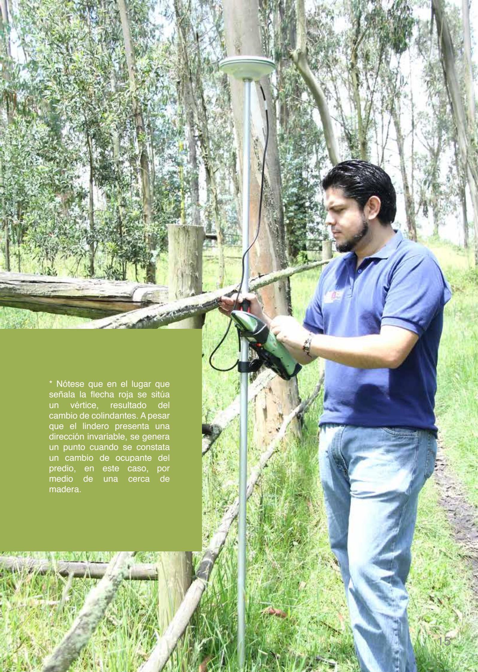
\* Nótese que en el lugar que señala la flecha roja se sitúa un vértice, resultado del cambio de colindantes. A pesar que el lindero presenta una dirección invariable, se genera un punto cuando se constata un cambio de ocupante del predio, en este caso, por medio de una cerca de madera.
