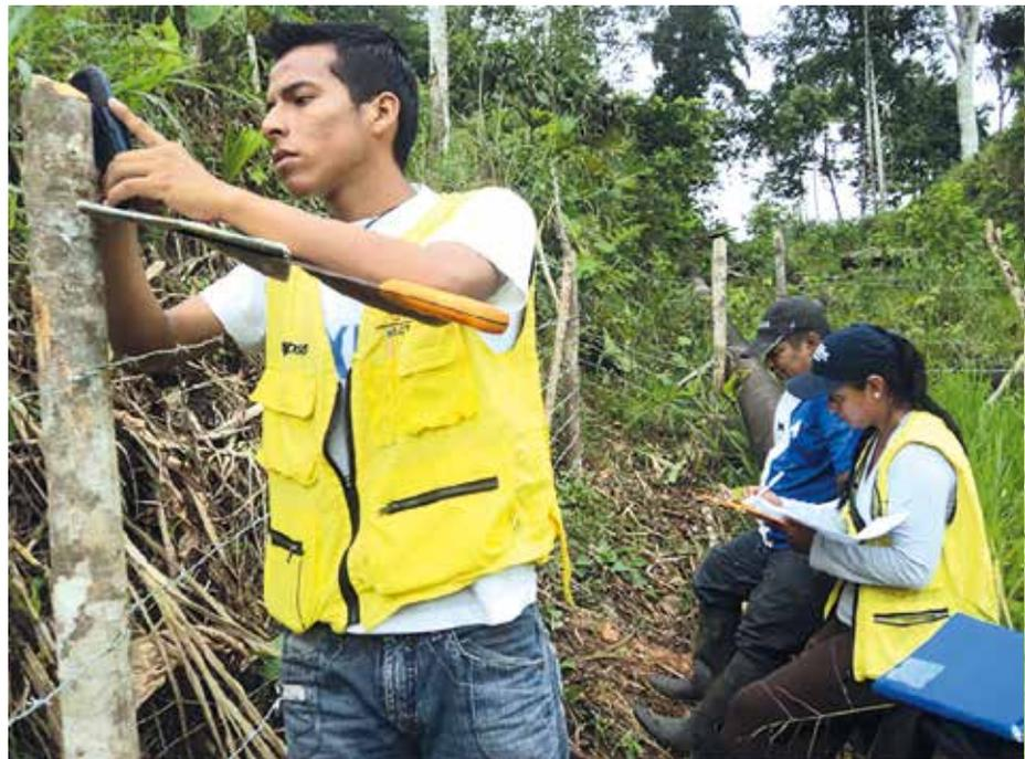
Figura 18: Vértice medido con buena recepción de señal GPS
