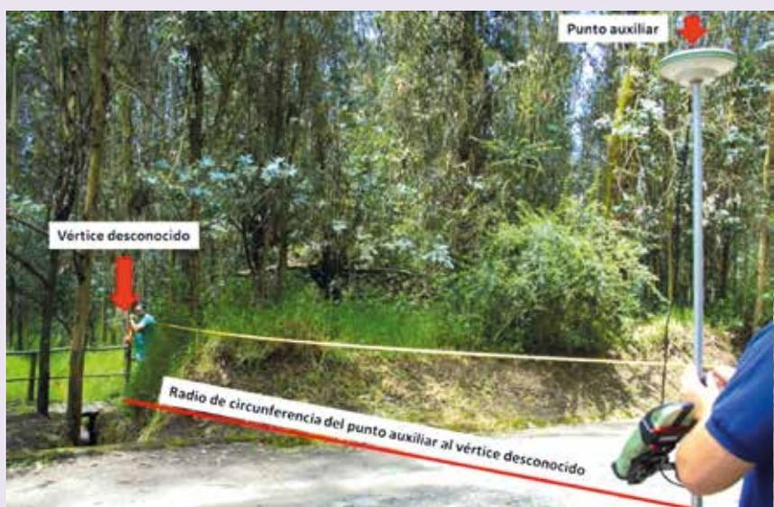
Figura 21: Determinación de vértices desconocidos no alineados a “puntos auxiliares” recepción
