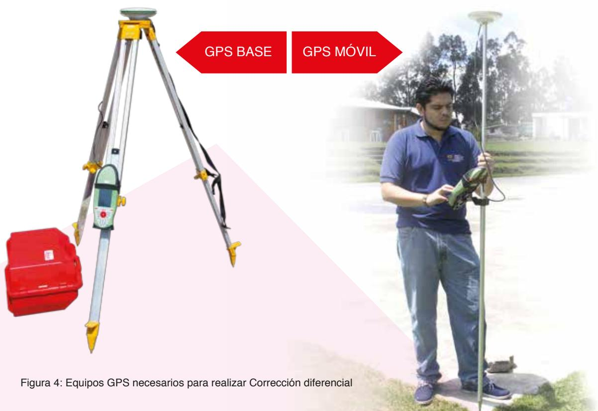
Figura 4: Equipos GPS necesarios para realizar Corrección diferencial
