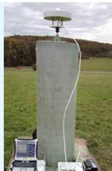
A los equipos GPS que permiten realizar Corrección diferencial o procesamiento diferencial se los conoce como DGPS (Differential GPS)
